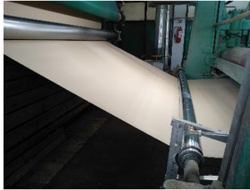
ј) доработка на хартија (премотување на хартијата во ролни)
