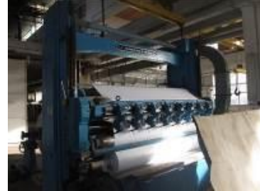
ј) доработка на хартија (премотување на хартијата во ролни)
