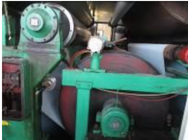
ж) формирање на хартиено платно со помош на вакуум, од овој процес водата се рециркулира назад во процесот на подготовка на пулпа
