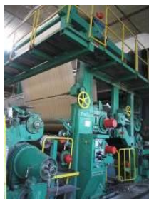
з) сушење на хартија со помош на пареа
