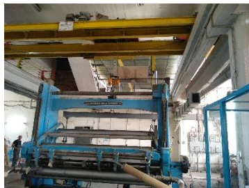
ј) доработка на хартија (премотување на хартијата во ролни)
