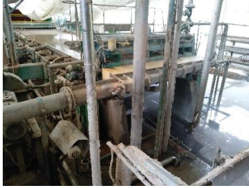
ж) формирање на хартиено платно со помош на вакуум, од овој процес водата се рециркулира назад во процесот на подготовка на пулпа
