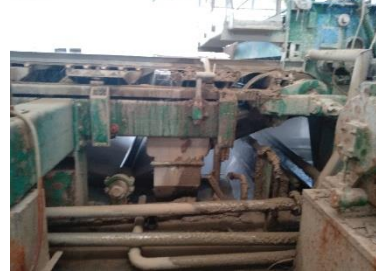
ж) формирање на хартиено платно со помош на вакуум, од овој процес водата се рециркулира назад во процесот на подготовка на пулпа
